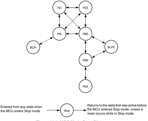
Figure 16-9. MCG Mode State Diagram
