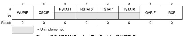
Figure 15-7. MSCAN Receiver Flag Register (CANRFLG)
