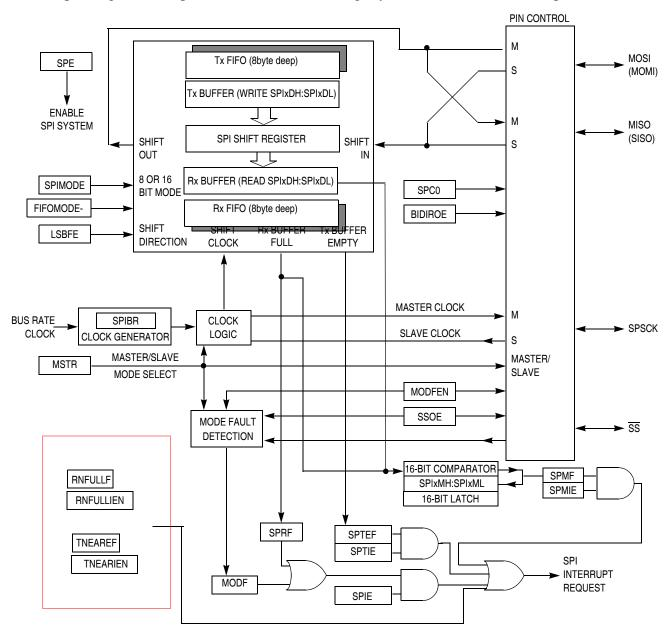
Figure 20-2. SPI Module Block Diagram
