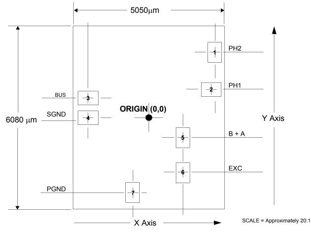
Figure 12. Die floor plan
