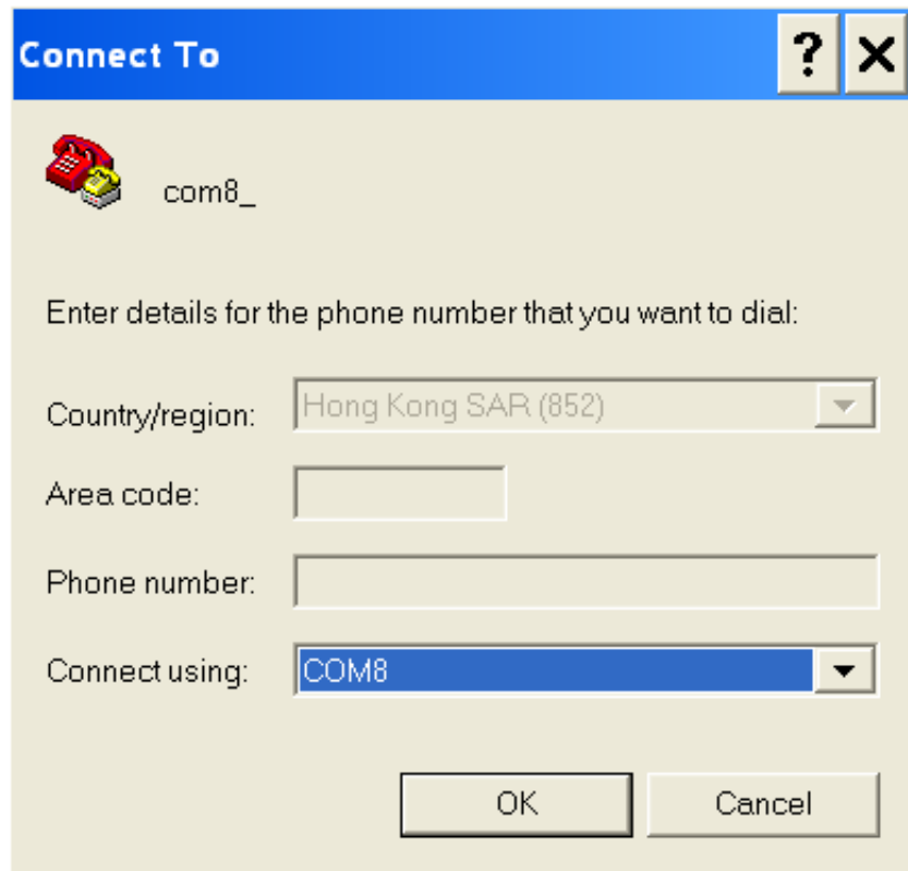
图 16. 使用 USB-RS232 COM 端口建立连接
