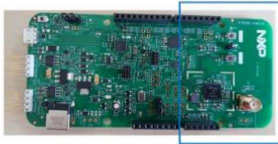
图 5. FRDM-KW36 测试板
