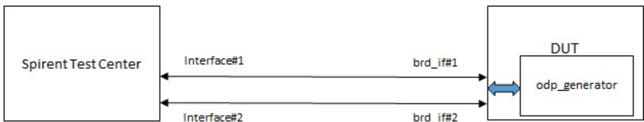
Figure 192. Test setup (odp_generator)
